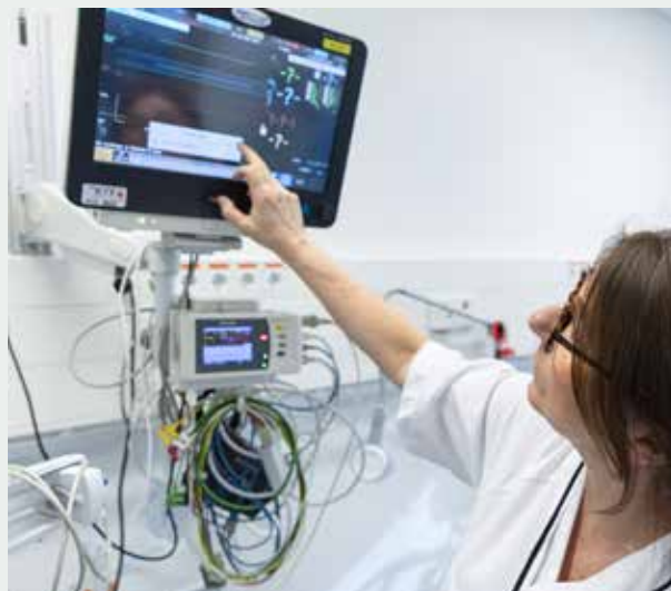
Her undersøkes det om scoopet fungerer, og at alle elektroder er på plass.
