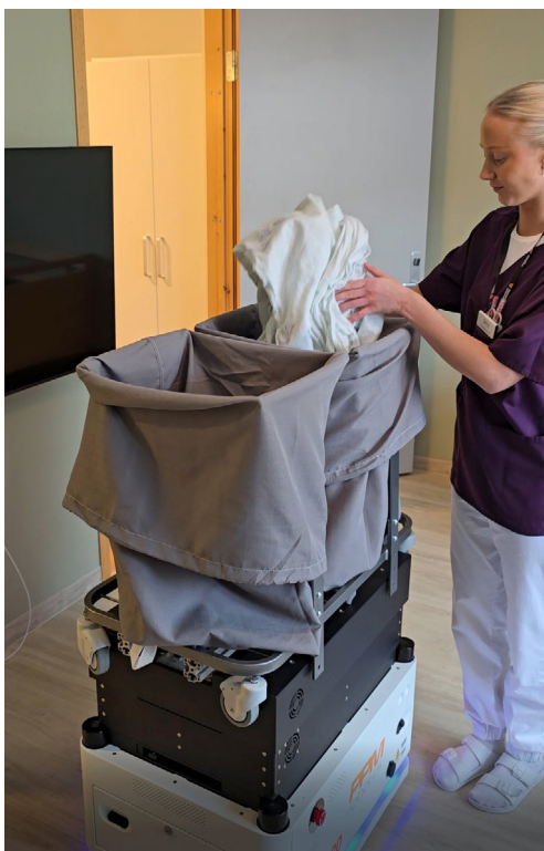
Denne roboten kan transportere saker. Her legges skittentøy ned i under et sengeskift. Når kurven er full sendes roboten til vaskeriet. Slik kan pleieren fortsette jobben uavbrutt. Foto: PPM Robotics AS
