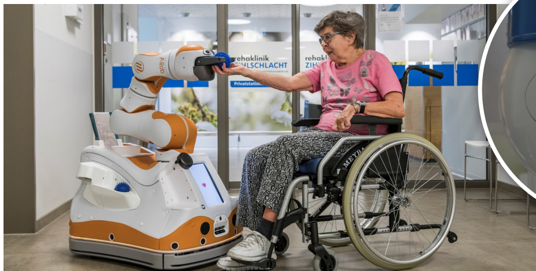
Robotarmen kan assistere pasienter, for eksempel når noen trenger drikke, eller å plukke noe opp fra gulvet. Foto: PPM Robotics AS
