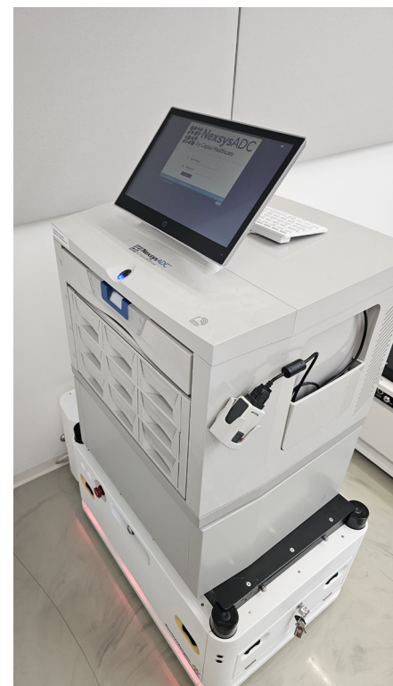
Transportroboten har en enkel form med ulike moduler som kan sette på toppen, alt etter bruksområde. Her har den et medikamentskap. Foto: PPM Robotics AS
